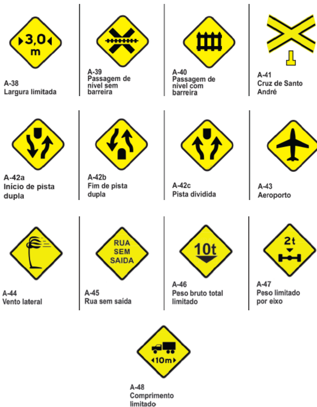
Figura 2 - Sinais de ADVERTÊNCIA
