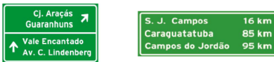
Figura 4 - Sinais de INDICAÇÃO - Placas de Orientação e Destino
